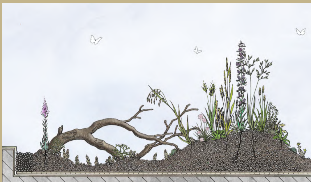
Coupe de principe (hors-échelle) d'une toiture végétalisée extensive, Source: ZHAW, Institut für Umwelt und Natürliche Ressourcen.
