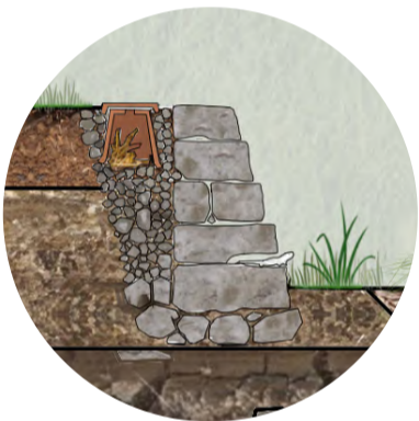
Mur en pierres sèches et cavités
