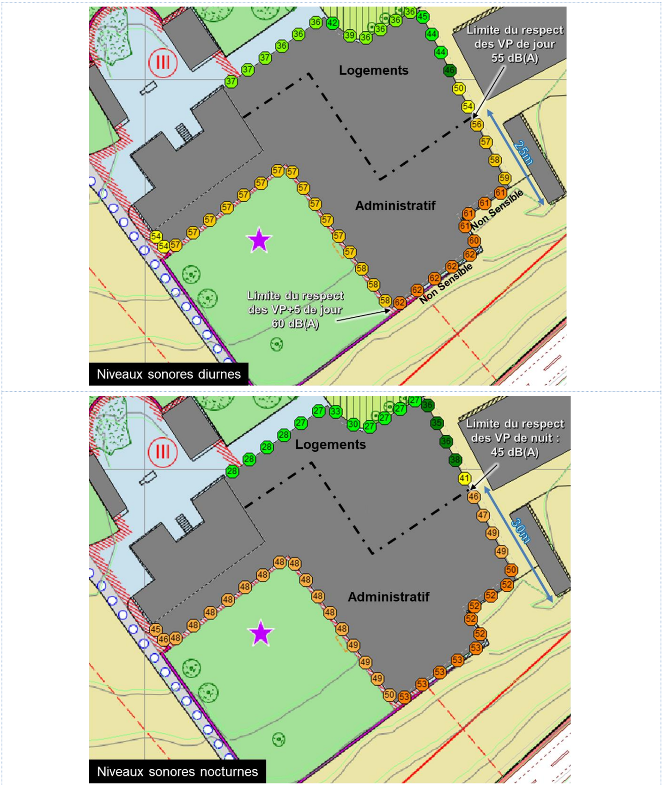
Figure 5.7 Niveaux sonores (valeurs maximales par point) au droit du bâtiment fictif du secteur 2
