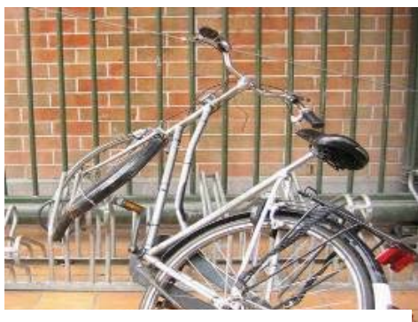
Fig.2: exemple de dégâts causés par un système d'attache sans sécurisation du cadre
