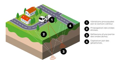
Le camion circulera de nuit afin de limiter les dérangements pour la circulation et de maximiser la précision des mesures. Le tracé du camion se fera sur la route et la majorité des capteurs seront disposés à leurs abords. Certains capteurs devront parfois être placés sur des parcelles privées avec l'accord de leurs propriétaires.
