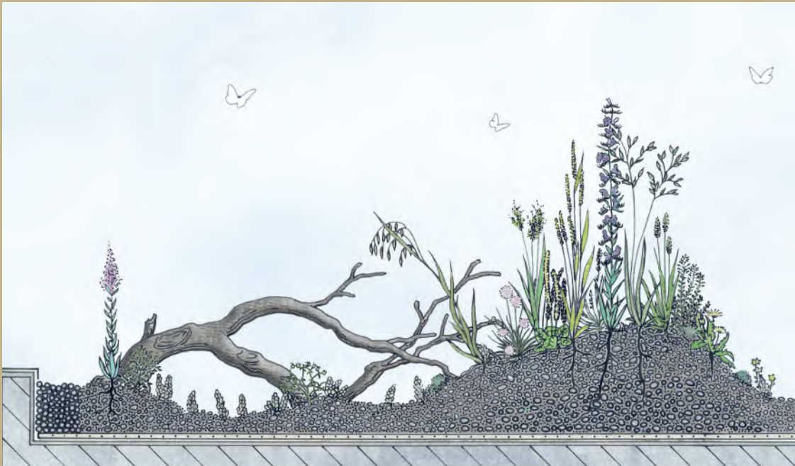
Coupe de principe (hors-échelle) d'une toiture végétalisée extensive, avec micro-topographie et bois sec pour les insectes. Source : ZHAW, Institut für Umwelt und Natürliche Ressourcen.
