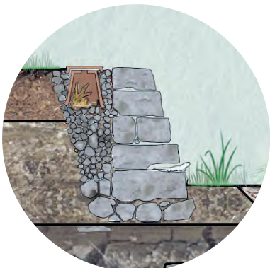
Mur en pierres sèches et cavités
