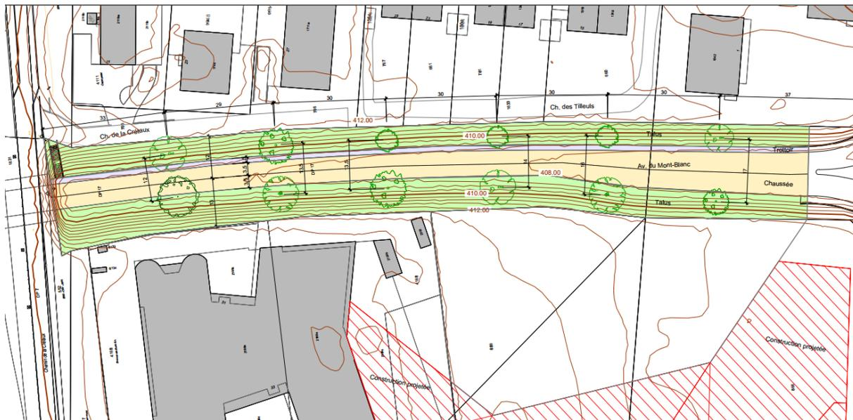
En coupe, la pente transversale en toit est d'environ 2 %. La hauteur des talus latéraux varie entre 3.7 [m] et 5.9. [m]. Au nord le passage inférieur permet à l'Avenue du Mont-Blanc de passer sous les voies CFF, le chemin de la Crétaux et la Route de Nyon.
