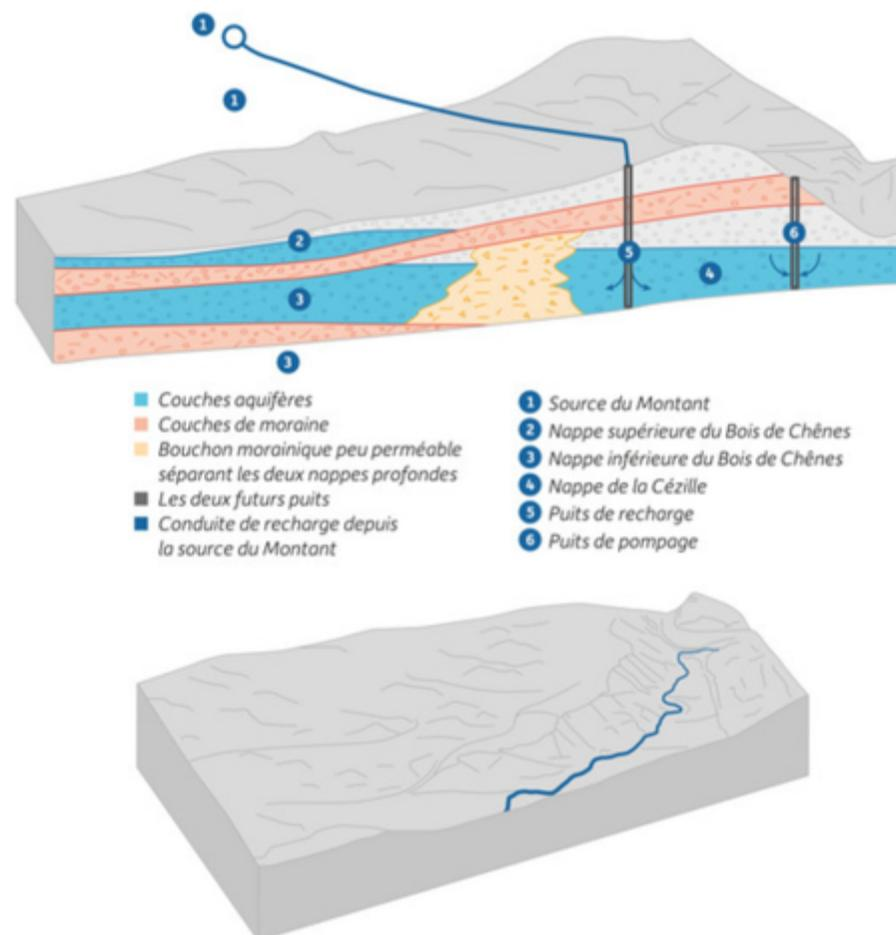
Figure 3 - Bloc-diagramme coupant le Bois-de-Chênes et la Cézille dans l'axe du "Sillon de la Côte" (Source - Prof. Aurèle Parriaux)
