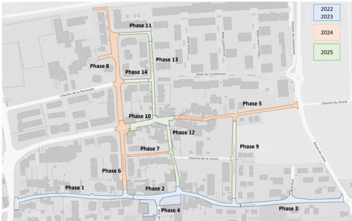
Figure 6 - phasage des travaux et années d'intervention
