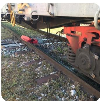
En date du 7 juillet 2020, le déraillement d'un convoi CFF-Cargo s'est produit à hauteur du sabot dérailleur Sb32 qui matérialisait la limite entre notre voie de raccordement privée et la voie appartenant aux CFF (voir plan en annexe n°5). Cet accident n'a fort heureusement causé que des dégâts matériels, la vitesse du convoi sur ce tronçon étant limitée à 10 km/h.
